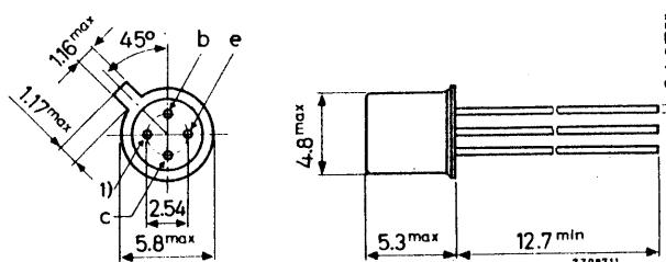
$$R_{th\ j-a} = 0.75 \text{ } ^\circ\text{C/mW}$$
