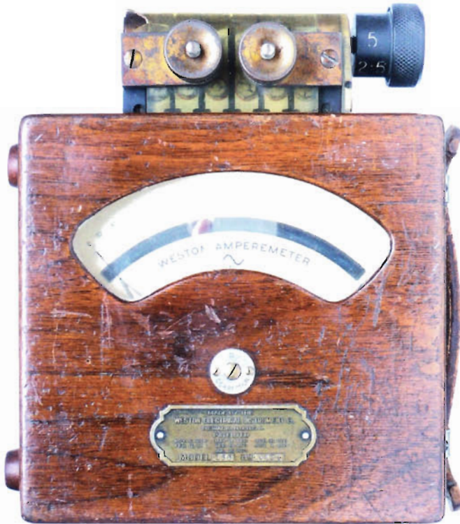
Fig 19a: Weston Ampèremeter (repulsion)
