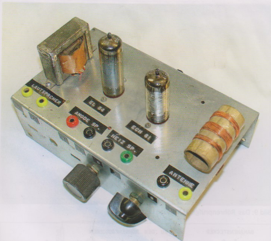
Bild 8: Das Kurzwellenaudion. Aufbau und Schaltung.
