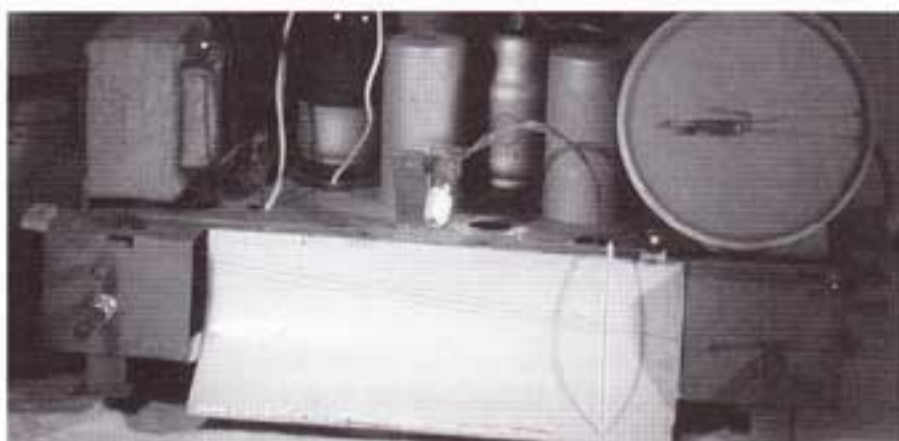
Bild 8: Skalenaufbau und -antrieb im Standard-Super 1948: bestens integriert!
