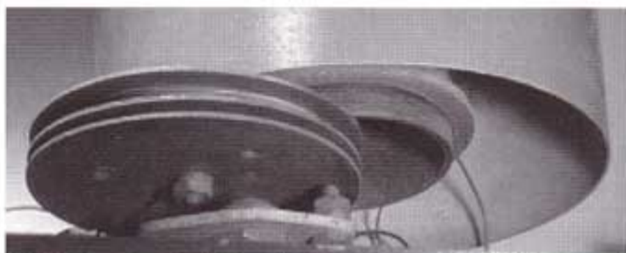
Bild 5: Schwenkspule in den Schaub Alpha- und Beta-Modellen von 1930.
