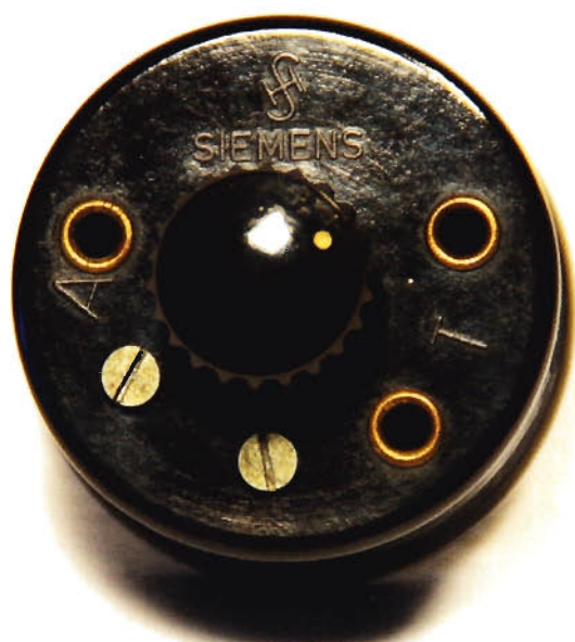
Bild 5: Siemens „Kurzwellen-Detektor-Empfänger“ mit zentralem Drehknopf, der den Keramik-Scheibentrimmer zwecks Senderabstimmung bewegt.
