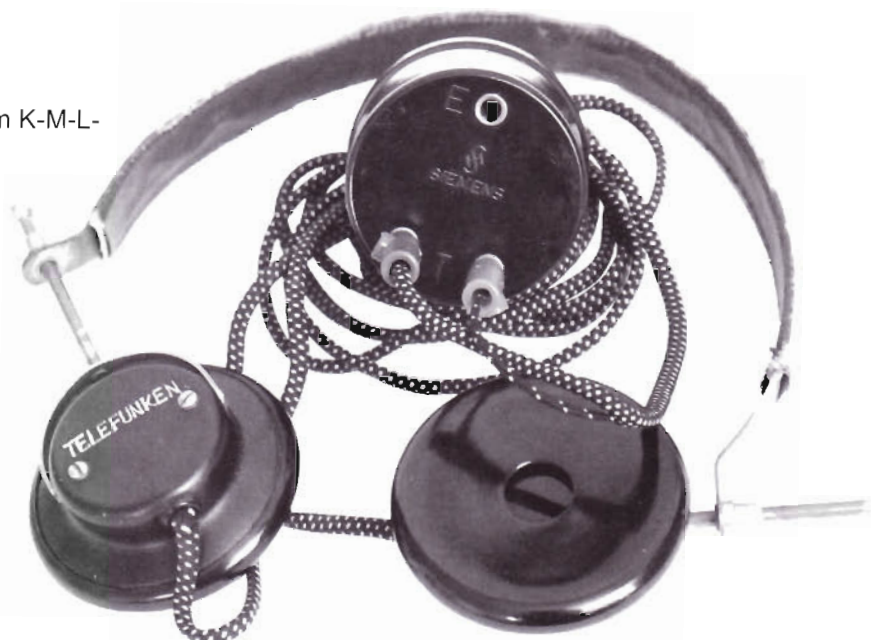
Bild 1: Siemens „Berlin-Stecker“ von 1946 mit einem Telefunken-Dopfkopfhörer einfachster Ausführung aus ersten Kriegsjahren.
