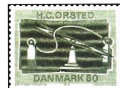
Bild 4: Kompassnadel neben stromdurchflossenen Leiter (Dänemark Mi. 498).
