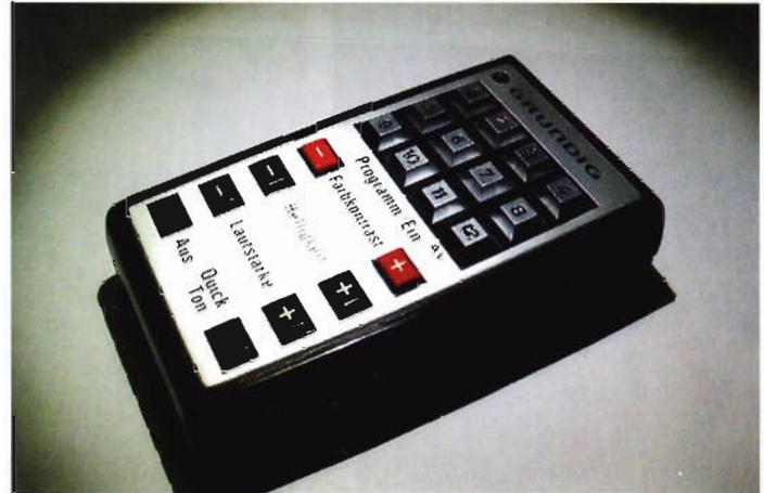
Ultraschall-Fernbedienung Telepilot 12 von Grundig.
