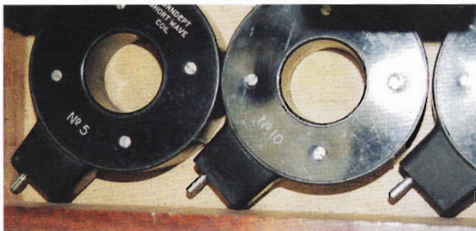
Bild 11. Empfangs-Steckspulen N° 3, 5, 10, 15, 20 für das 27- bis 43-; 40- bis 60-; 55- bis 80-; 70- bis 100-m-Band.
