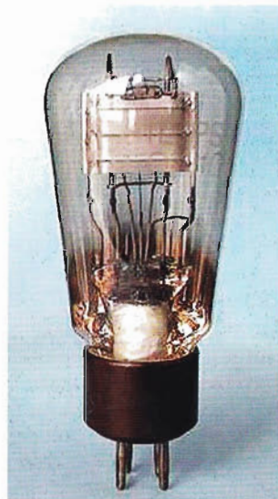
Bild 18. Senderöhre TB4/10 von Philips. Heizung 7,5 V / 1,25 A, Anodenleistung 10 W bei 400 V / 0,5 A.
