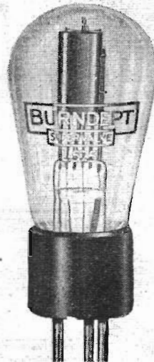
Bild 10. Ersatzröhre L525 von Burndept.
