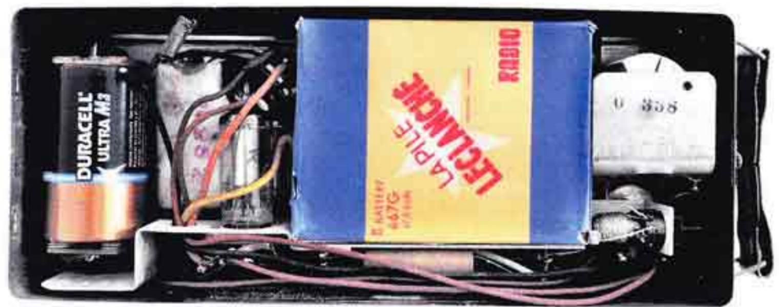
Figure 30. — le RCA Victor BP-10 sous tension.
