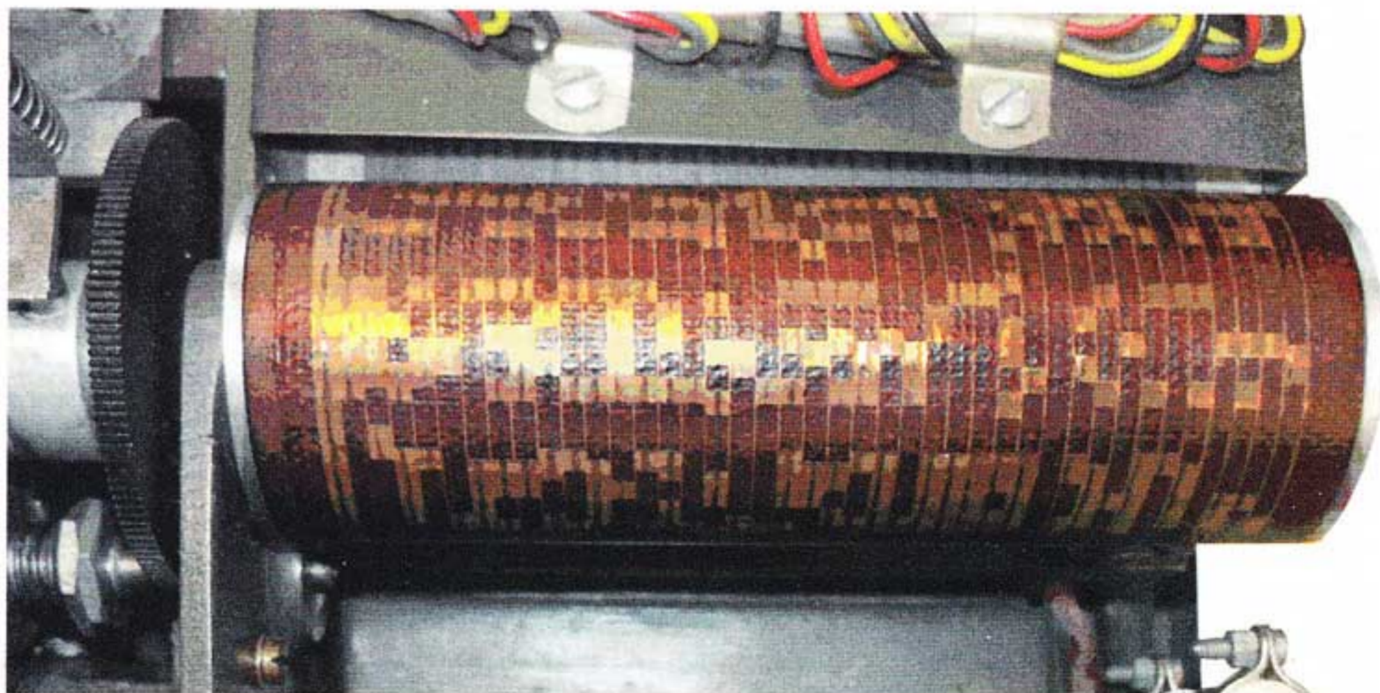
Figure 10. — Vue de détail du tambour avec les bandes cuivrées.
