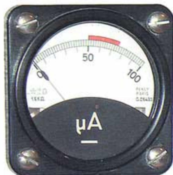
Figure 21c. — Indicateur analogique du récepteur de trafic AME7G.
