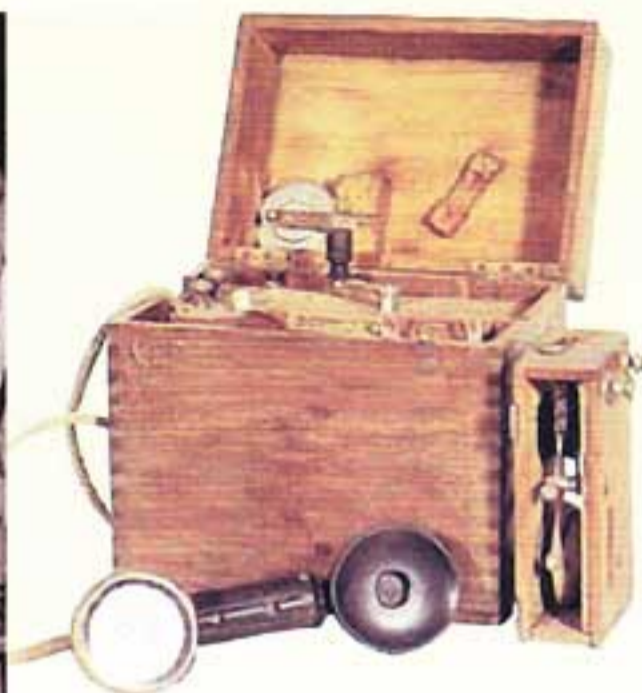
Figure 2. — PC de transmission [8] et téléphone de campagne TM 1916 [2].
