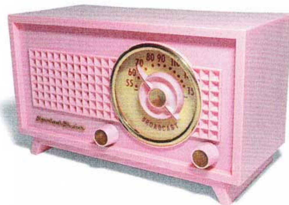
Récepteur secteur à tubes Standard Electric « Virtuose » modèle 1050, années 1950. Origine Brésil probable. En plaskon, a été produit en nombreuses couleurs. Uniquement PO.
