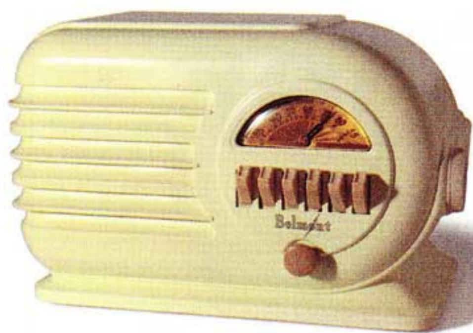
Radio à lampes secteur 110 volts Belmont modèle 6D120 de 1947, en bakélite peinte, USA. Les boutons du clavier sont en acétate de cellulose, le cadran en celluloïd et le gros bouton de droite en Plaskon. PO uniquement avec 6 stations pré-réglées.
