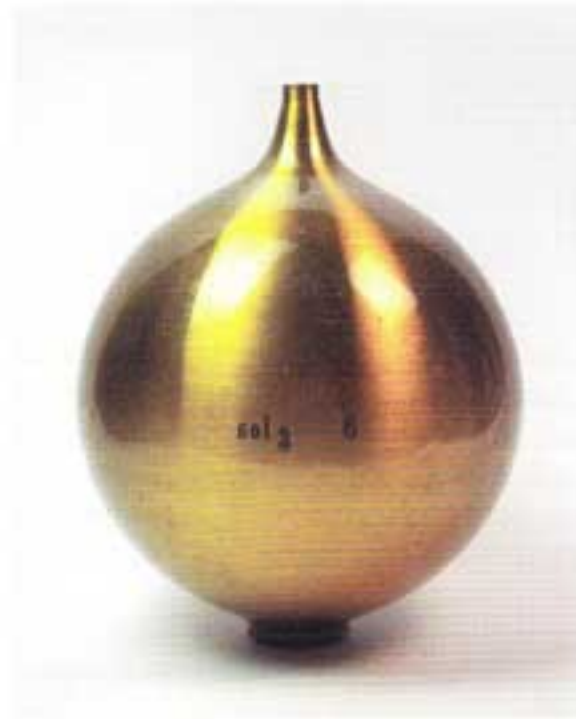
Figure 4. — Résonateur de Helmholtz (photo Wikipédia).
