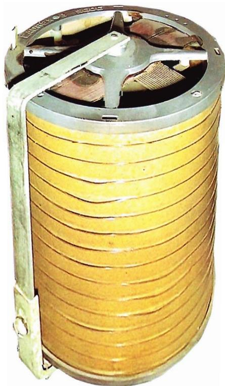
Figure 15. — Cadre à air cylindrique.
