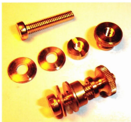
Figure 3. — Bornes, plots et boutons moletés en laiton.
