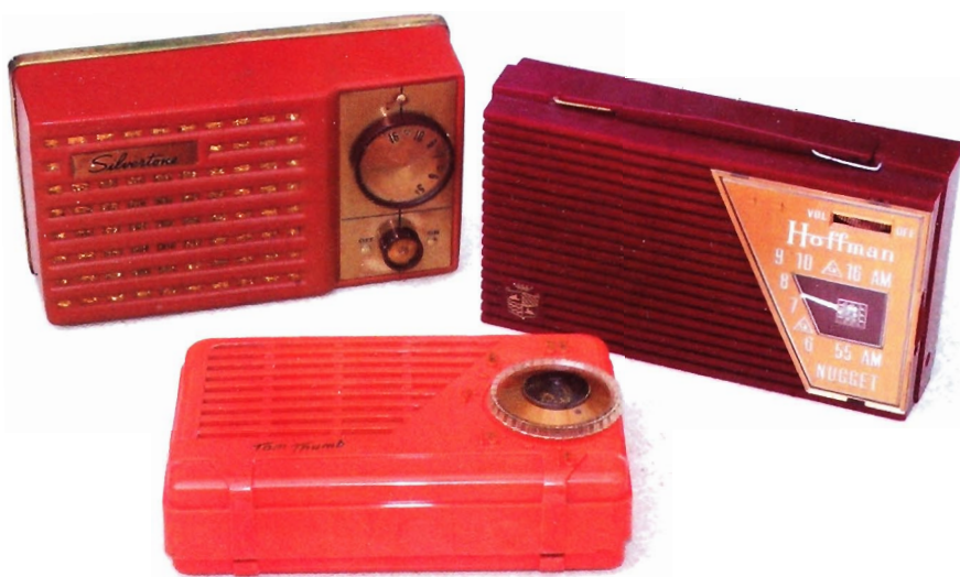
Figure 3. — Trois postes au format pocket : Tom Thumb de Automatic, Hoffman Nugget et Silverstone 4212. Ce dernier a la particularité d'utiliser deux tubes « crayon » et deux tubes miniatures.
