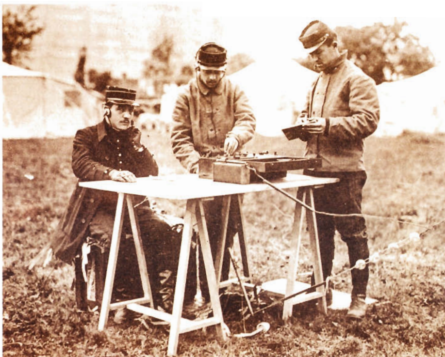
Figure 14. — Boîte probablement du type TM 1 modèle 1915, on distingue sur le côté de la boîte la self d'accord de l'antenne, c'est toujours une bobine Oudin mais à plots, l'accord se fait par la manœuvre de deux commutateurs (Droits réservés).
