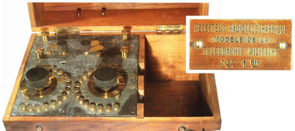
Figure 15. — Boîte du type TM 1 bis modèle 1915 et son étiquette, c'est un montage du type Tesla qui annonce la boîte type A (Collection des Arts et Métiers, photo A. Salles).
