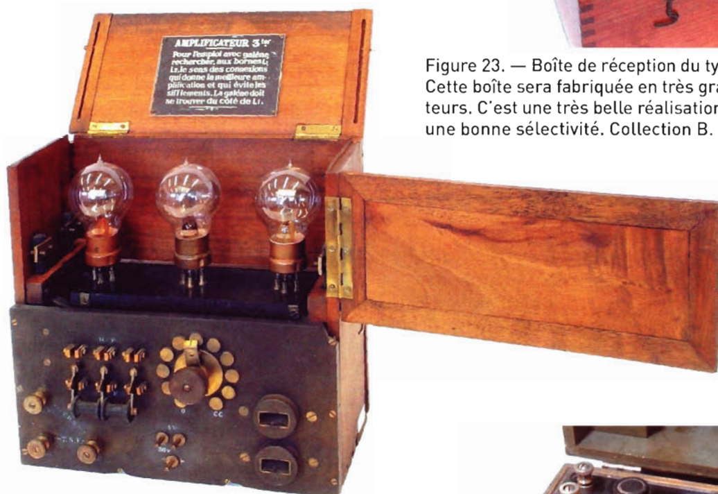
Figure 24 (ci-dessus). — L'industrialisation en 1915 de la première lampe triode va permettre de construire de nombreux types d'amplificateurs. Le plus célèbre d'entre eux est l'amplificateur à trois lampes, l'amplificateur 3 ter modèle 1916. Cet amplificateur à usage général (TSF mais aussi télégraphie par le sol) sera en particulier utilisé conjointement avec la boîte A améliorant ainsi très sensiblement les performances de cette dernière. Ces amplificateurs seront en priorité affectés à l'A.L.G.P. Collection M.G.
