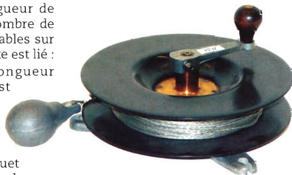
Figure 11. — Rouet d'antenne. Il permet d'enrouler et de dérouler l'antenne dont la longueur ne dépasse pas en règle générale les 80 m. Au bout du fil est attaché un poids qui facilite le déploiement et la tension du fil. Il existe généralement à bord, depuis une expérience malheureuse en 1910 des premiers expérimentateurs de TSF à bord, une cisaille permettant de couper le fil en cas d'urgence (traversée de nuages orageux, passage à basse altitude au-dessus d'une zone boisée...). Collection M.G.
