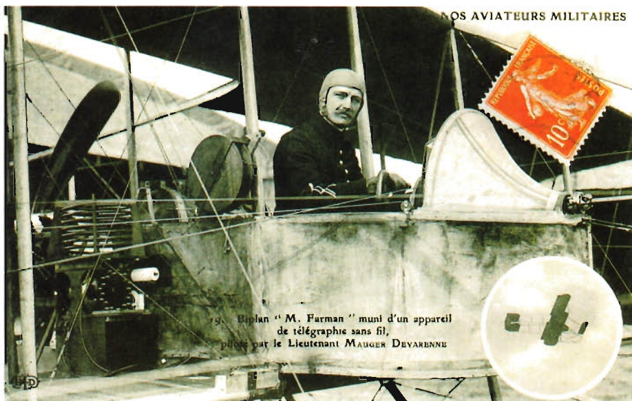
Figure 13. — L'entraînement de l'alternateur par le moteur de l'avion est une solution qui sera mise en concurrence un temps avec le moulinet. On distingue ici sur un biplan Farman, le disque tournant de l'éclateur, disque entraîné par le moteur. Le moulinet sera cependant préféré, l'entraînement par courroie s'avérant moins fiable et requérant des modifications mécaniques du moteur. Collection P. Blavette.
