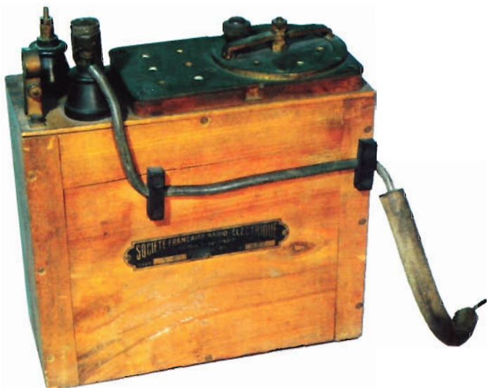
Figure 20. — Boîtier « Circuit Oscillant » de COY 6, réalisé plus particulièrement pour fonctionner avec l'alternateur Y. Le boîtier ne possède pas d'éclateur fixe sur son dessus, l'émetteur ne fonctionne qu'avec un éclateur tournant. On lui préférera par la suite le boîtier COK 12. Musée des arts et métiers. Photo A. Salles.
