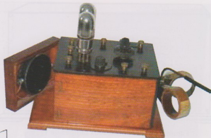
Figure 10. — Bi-lampe de 1924 à selfs interchangeables en entrée.
