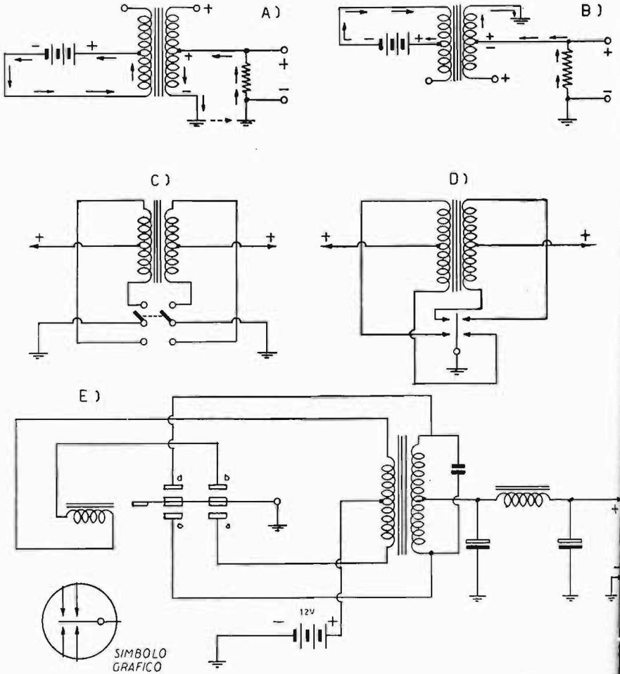
Fig. 10.4. - Il vibratore sincrono, del quale questa figura illustra il principio, provvede anche al raddrizzamento della tensione alternativa, sostituendosi alla valvola raddrizzatrice.
