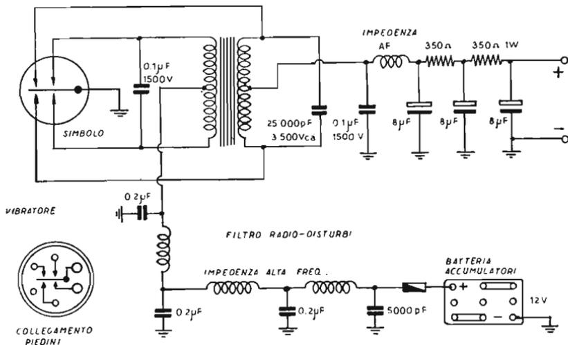
Fig. 10.8. - Esempio di filtro radiodisturbi con vibratore sincro.
