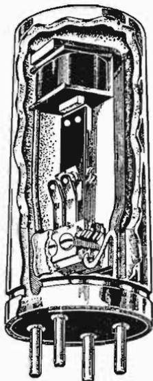
Fig. 10.5. - Parti componenti il vibratore sincrono.
