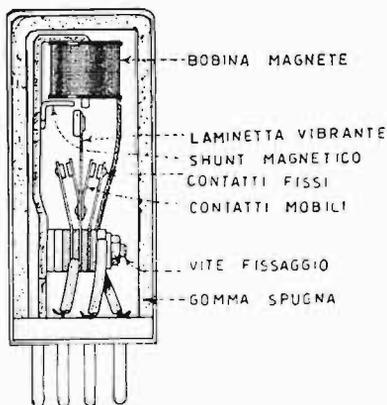
Fig. 10.2. - Parti componenti il vibratore di tipo asincrono.
