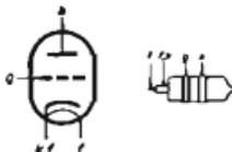
TRIODO PER ULTRAFREQUENZE SINO A 3000 MEGACICLI (10 centimetri). - Senza piedini, tipo disc-sealed. Griglia e placca sono collegate a diachi metallici interni (terminanti con anelli esterni). Dal fondo esce un cilindretto (catodo e un filamento) dal centro del quale esce un conduttore (altro filamento). G - 30.
